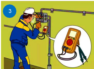
3. Verificar la ausencia de tensión.
