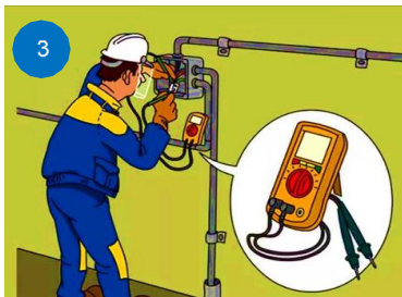
3. Verificar la ausencia de tensión.
